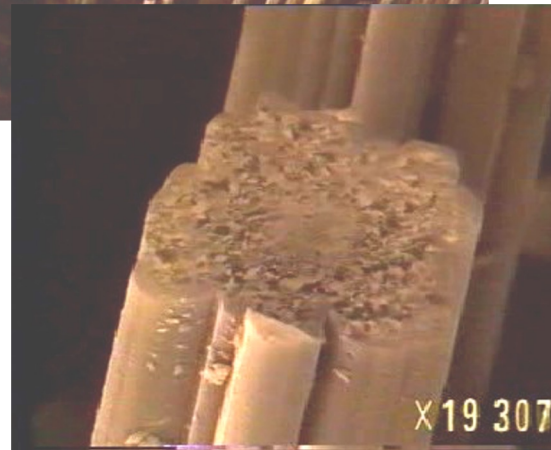
Fibres de carbone enrobées dans une matrice époxy (1-10 \mu\text{m} )
